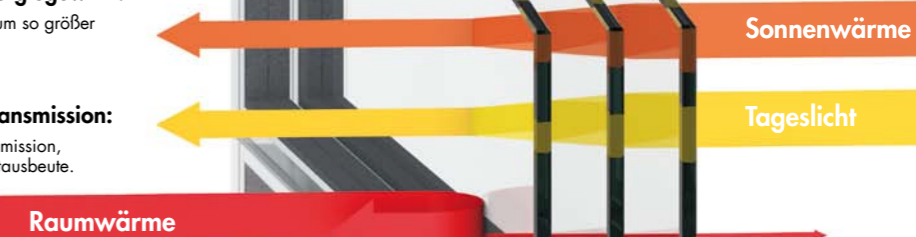
Der spezielle Scheibenrandverbund mit „warmer Kante“
